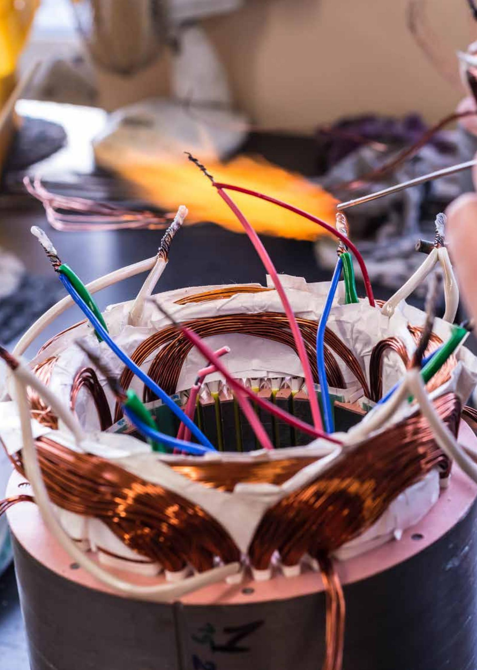
Schutzisolierte Litzen- oder Einzel-Leiter für die Anwendung als temperaturresistente Anschlussleitung in elektrischen Maschinen, Transformatoren und Serienanwendungen der Elektrotechnik und Elektronik.
